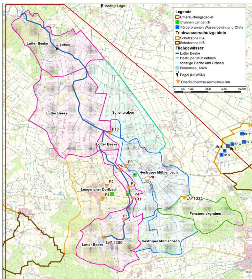
Abbildung 21: (Teil-)Einzugsgebiete der Lotter Beeke (farbige Flächen) und Pegel im Untersuchungsgebiet
